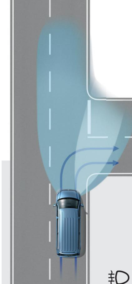
**Faros antiniebla con luz de giro.** Aseguran una óptima visibilidad en condiciones meteorológicas adversas. El faro más cercano a la esquina ilumina la carretera al girar.<sup>2)</sup>
