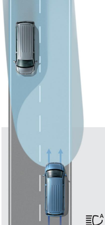
**Asistente de luces de carretera «Light Assist».** Regula automáticamente las luces para evitar deslumbrar a los vehículos que vienen de frente o por delante. Conduciendo a más de 60 km/h y en completa oscuridad, el sistema enciende automáticamente las luces de carretera.<sup>4)</sup>
