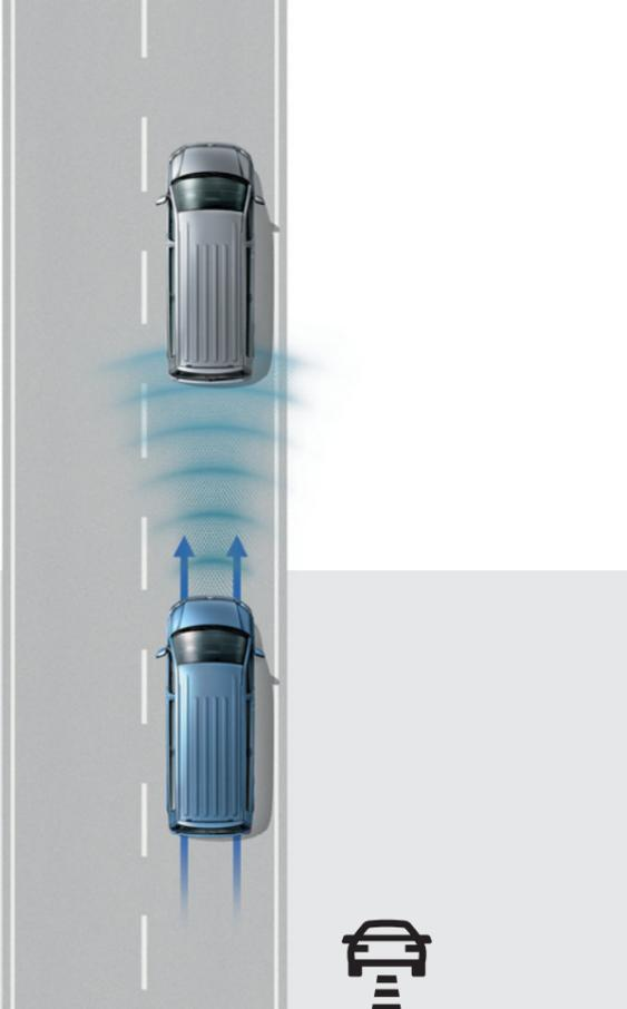
**Control de Crucero Automático (ACC).** Adapta automáticamente la velocidad en relación al vehículo que va delante y mantiene la distancia especificada por el conductor. Avisa en caso de una aproximación a una velocidad excesiva y en caso de emergencia produce tanta presión de frenado que es capaz de reducir la gravedad de una colisión o incluso puede llegar a evitarla.
