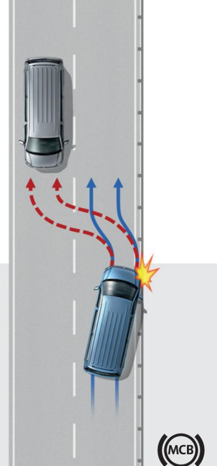
**Sistema automático de frenado poscolisión.** Los mecanismos frenan después de una colisión, con el objetivo de prevenir colisiones secundarias. El sistema automático de frenado poscolisión se activa cuando el vehículo detecta un accidente. Después de unos segundos, el vehículo comienza a frenar por etapas hasta alcanzar los 10 km/h y durante dicho intervalo el conductor puede asumir el control en cualquier momento.<sup>1)</sup> <sup>2)</sup>
