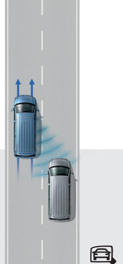
**Asistente de cambio de carril «Side Assist».** Se muestra una señal de advertencia en el espejo exterior<sup>1)</sup> tan pronto como uno de los sensores detectan un vehículo en el ángulo muerto de visión durante un cambio de carril.<sup>4)</sup>
